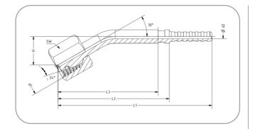
Für DN4 TECALAN-Schlauch Typ BA04, AF4, AF4CU, GE4, 250DN4
