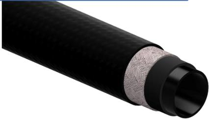
**Niederdruck-Schlauch aus synthetischem Gummi, mehrlagig, textilverstärkt, DIN 73379 Typ 3E folgend, als Förderleitung für technische Medien**
