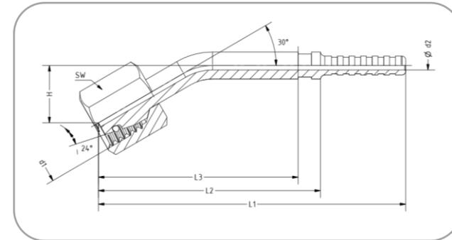
Für DN4 TECALAN-Schlauch Typ BA04, AF4, AF4CU, GE4, 250DN4
