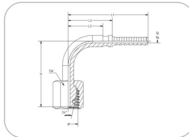
Für DN4 TECALAN-Schlauch Typ BA04, AF4, AF4CU, GE4, 250DN4
