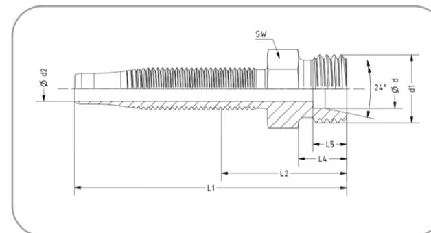
Für TECALAN-Schlauch Typ AF, AF...Cu, BF, BF...Cu
