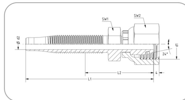
Für TECALAN-Schlauch Typ AF, AF...Cu, BF, BF...Cu
