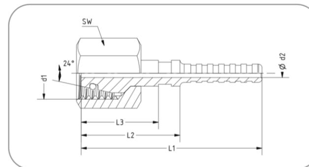
Für DN4 TECALAN-Schlauch Typ BA04, AF4, AF4CU, GE4, BF4, 250DN4
