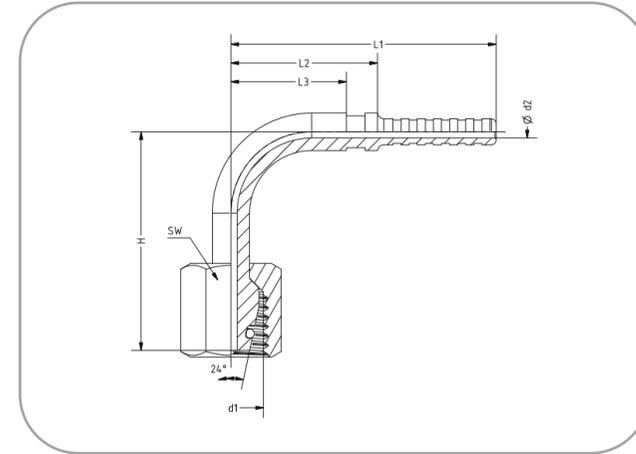
Für DN4 TECALAN-Schlauch Typ BA04, AF4, AF4CU, GE4, BF4, 250DN4
